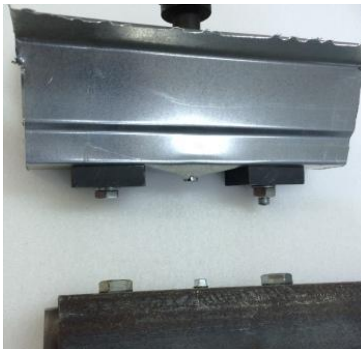
Рисунок 4 – детали после разрушения соединения с одним профилированным листом толщиной 0,7мм.
