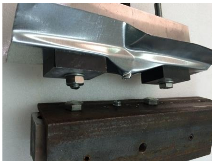
Рисунок 2 – детали после разрушения соединения с одним профилированным листом толщиной 0,5мм.
