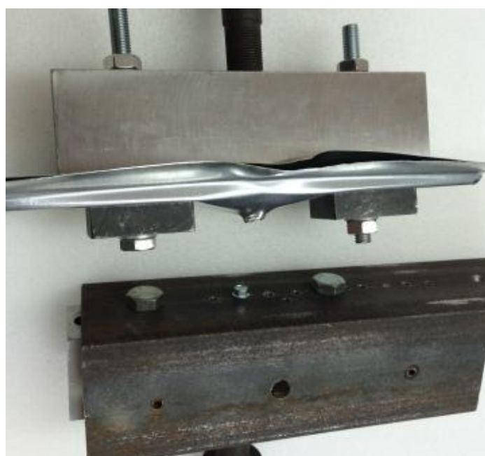
Рисунок 3 – детали после разрушения соединения с двумя профилированными листами толщиной 0,5мм.
