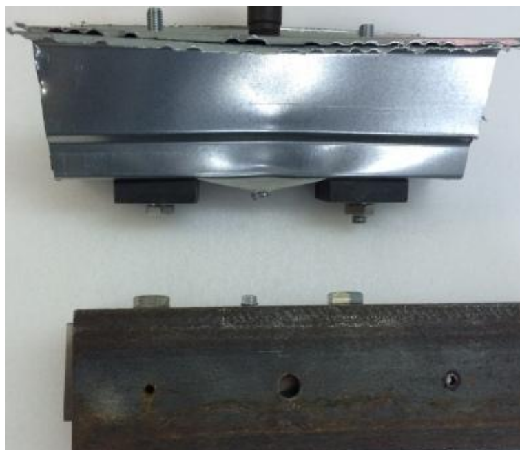
Рисунок 5 – детали после разрушения соединения с двумя профилированными листами толщиной 0,7мм.
